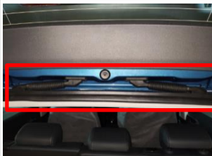
3.2 把我司 电源线束 从此处波纹管穿过引至尾门上
