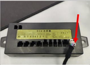
3.23 接控制信号线 解码器粉色控制信号线接我司ECU的开关延长线中黑色线，尽量靠 ECU 端接线
