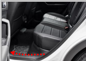
3.4 布正极线 将连接正极的线如图所示, 通过尾箱后, 把左 C 柱及迎宾踏板掀开线穿过将正极线引至 B 柱 ; ( 同时布解码器控制信号线 )
