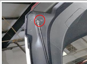
2.5 拆下原车上万向头,换上我司配有的万向头
