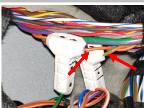
3.21 接解码器信号线：橙棕色线为 CAN-L 要和解码器线束中的绿黑线相接，橙绿色线为 CAN-H 要和解码器线束中的绿线相接
