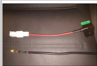
3.7 接正极线 : 把正极取电器接驳 ;
