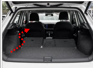
3.3 布正极线 : 将正极延着虚线引至左 C 柱 ; ( 同时布解码器控制信号线 )
