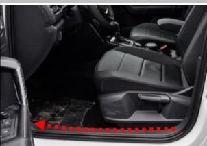
3.5 布正极线 : 把正极线从 B 柱引至前门迎宾踏板隐藏 ; ( 虚线 ) ( 同时布解码器控制信号线 )
