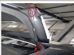
2.2 用一字螺栓刀把原车撑杆头翘起、拆下;
