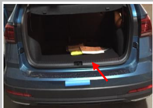
1.1 使用撬板把原车后踏盖拆下
