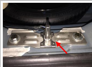
1.3 根据锁扣组箭头朝向正确安装，用原车螺母把垫板平行拧紧，注意居中安装
