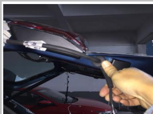
2.9 把防水胶塞卡进已经开好的孔 ; , 右边同样方法安装
