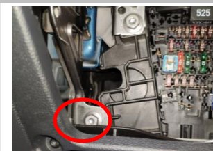
3.17 解码器负极：用解码器负极接此箭头位置连接负极
