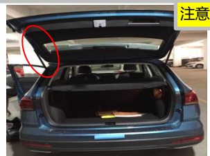
2.1 拆原车气弹簧:把原车左右两边气弹簧拆卸,提示:拆原车撑杆时需有人撑起尾门,防止掉下;
