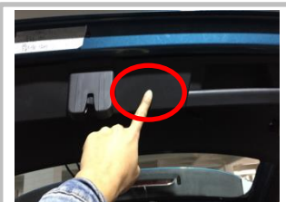
4.3 尾门开关安装：尾门右侧
