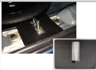
1.8 盖上我司配有的门锁盖板(示意图为已经盖好效果图)
