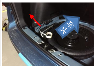
1.4 拆除尾箱左侧内饰板；注意：保护卡扣
