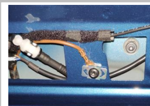
3.16 接负极：松动螺母，卡进负极连接片，卡紧后再还原拧紧螺母
