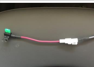
3.8 接正极线 : 把正极取电器接驳 ;
