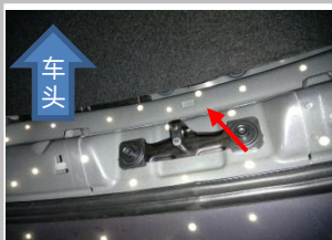
1.2 拆下原车锁扣组
