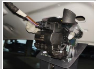
3.25 接门锁信号线 ：上门锁扣背后如图此位置拆下原车插头连接器，；用我们配的转接线连接，再把我司转接线插头（箭头）插进上门锁注意如图拍摄角度
