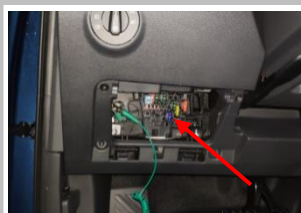
3.6 布正极线 : 在驾驶室中控台储物抽屉后, 可看到原车保险盒 ; ( 如图箭头所示 )
