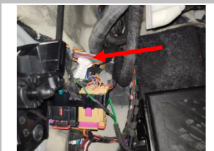
3.19 接解码器信号线：如图角度正视图内正确找到原车黑色线束，拆下黑色胶布；（通往左前门的线束）
