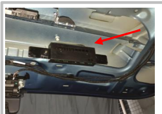
4.1 使用 M6*16+滑槽将 ECU 固定在尾门板内钣金上：图示为已经安装好的 ECU
