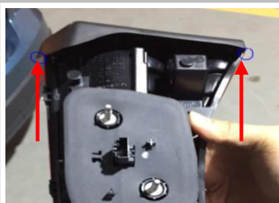
2.7 尾灯塑料需割胶走线 :具体割胶长度以实际装车为准。
